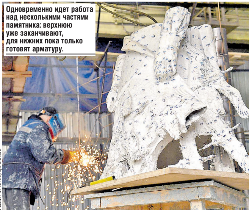
По точкам, размеченным на уменьшенной гипсовой копии солдата, изготовили большой каркас, который теперь покрывают раствором.
