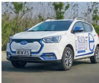
**JAC iEV75** – хетчбэк с электродвигателем мощностью 115 л.с. Разгоняется с 0 до 100 км/ч за 12 секунд, максимальная скорость ограничена 130 км/ч. Тяговая батарея емкостью 39 кВт·ч обеспечивает запас хода 280 км.
