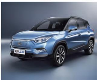
**JAC iEV54** – легкий кроссовер с электродвигателем мощностью 150 л.с. Максимальная скорость – 150 км/ч. Запас хода с батареей 55 кВт·ч – 355 км, 61 кВт·ч – 402 км.
