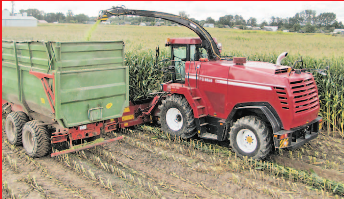
■ Комплекс высокопроизводительный кормоуборочный «ПАЛЕССЕ FS 8060».
